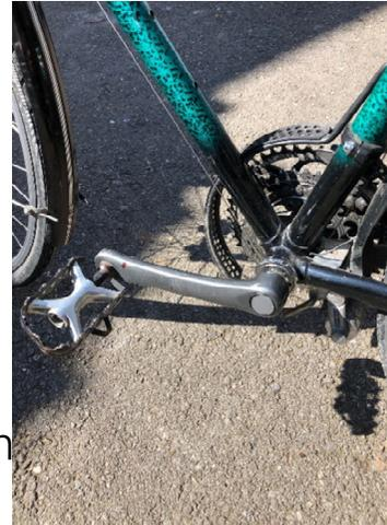
**Test :** L'état du roulement est testé en saisissant le bras du pédalier et en exerçant une pression le long de l'axe horizontal.
